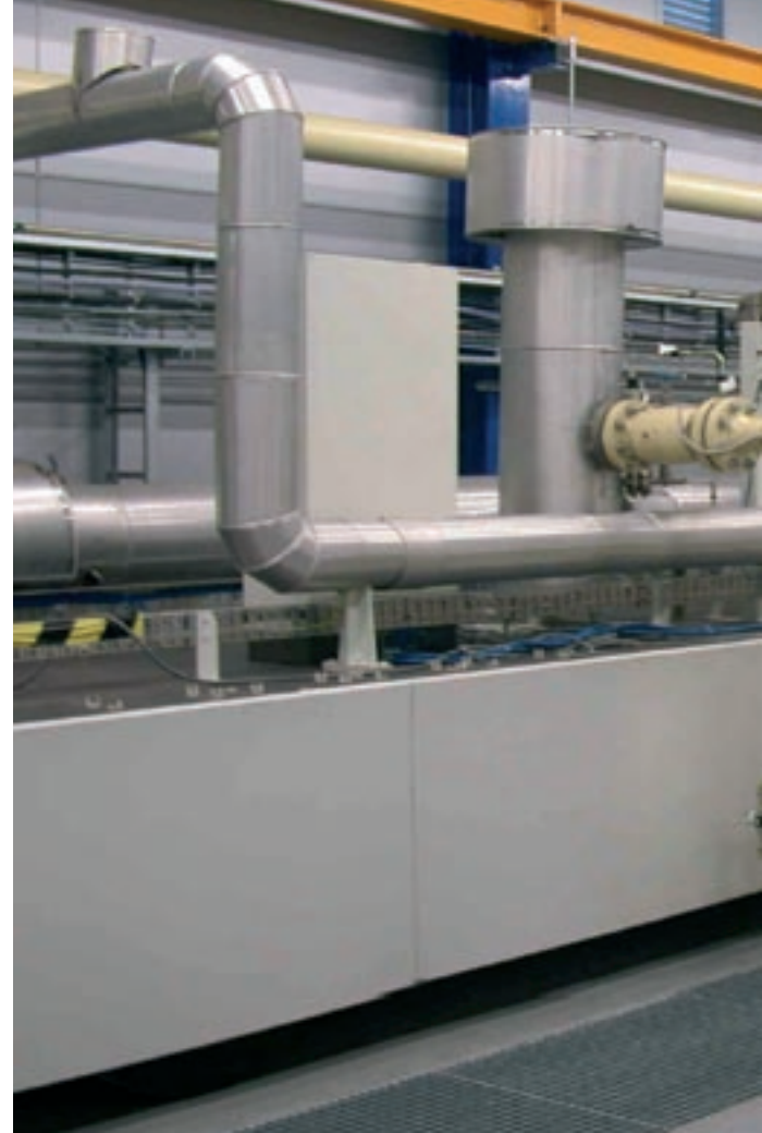
Patrón primario volumétrico para gas natural de alta presión (patrón primario tipo pistón)
